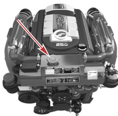
ヒートエクスチェンジャー、タンク
