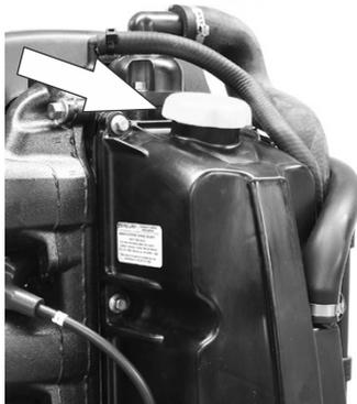
**重要：** オイルが汚染されていないかどうか点検します。水で汚染されたオイルは白濁しており、燃料で汚染されたオイルは強い燃料のにおいがします。オイルが汚染されていると判断した場合、ディーラーでエンジンの点検を受けてください。
